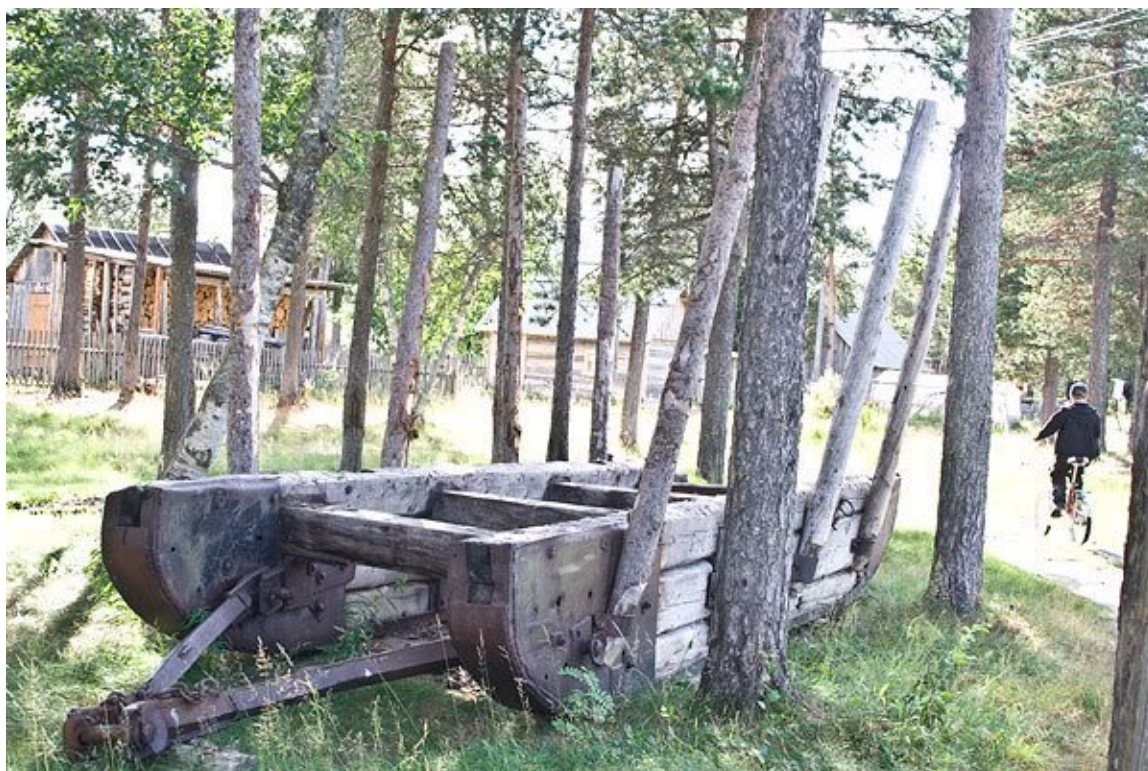
Огромные сани с обитыми металлом полозьями используются для перемещения грузов по зимникам
